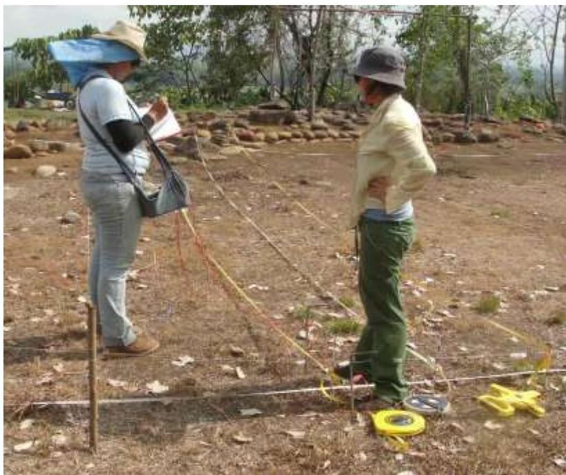
Fig. 77 Toma de datos de resistividad eléctrica
